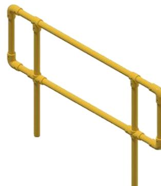
**Descripción:** Elemento estructural obtenido mediante el ensamblaje de perfiles pultrusionados y accesorios moldeados, de polímeros técnicos con una base de resina isoftálica y fibra de vidrio tipo E.
